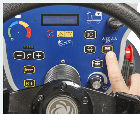
Børstehoved/sugefod sænkes automatisk, hvilket aflaster operatøren
